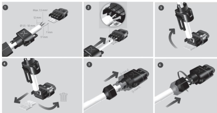
Рис. 9 Установка электроразъема
